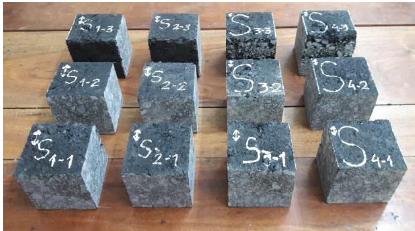
Figura 12. Probetas cúbicas generadas por aserrado para análisis a fatiga, Caso 4
